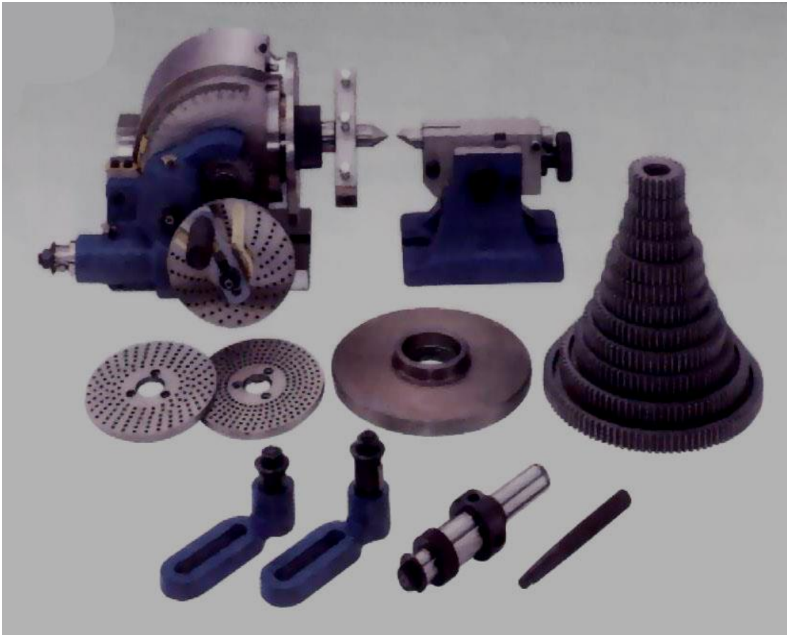
Hình 1.1 Đầu phân độ vạn năng và phụ tùng kèm theo
